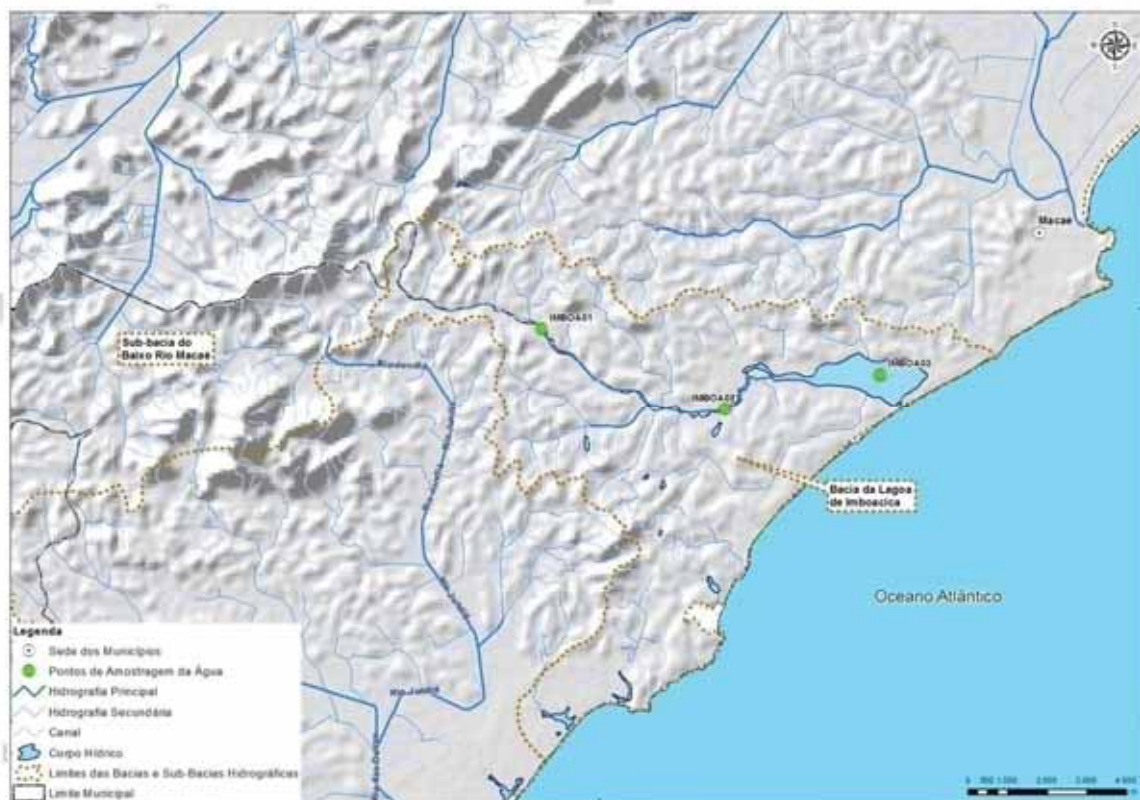
Figura 7.40: Distribuição dos Pontos de Amostragens de Água Superficial na Bacia da Lagoa de Imboacica
