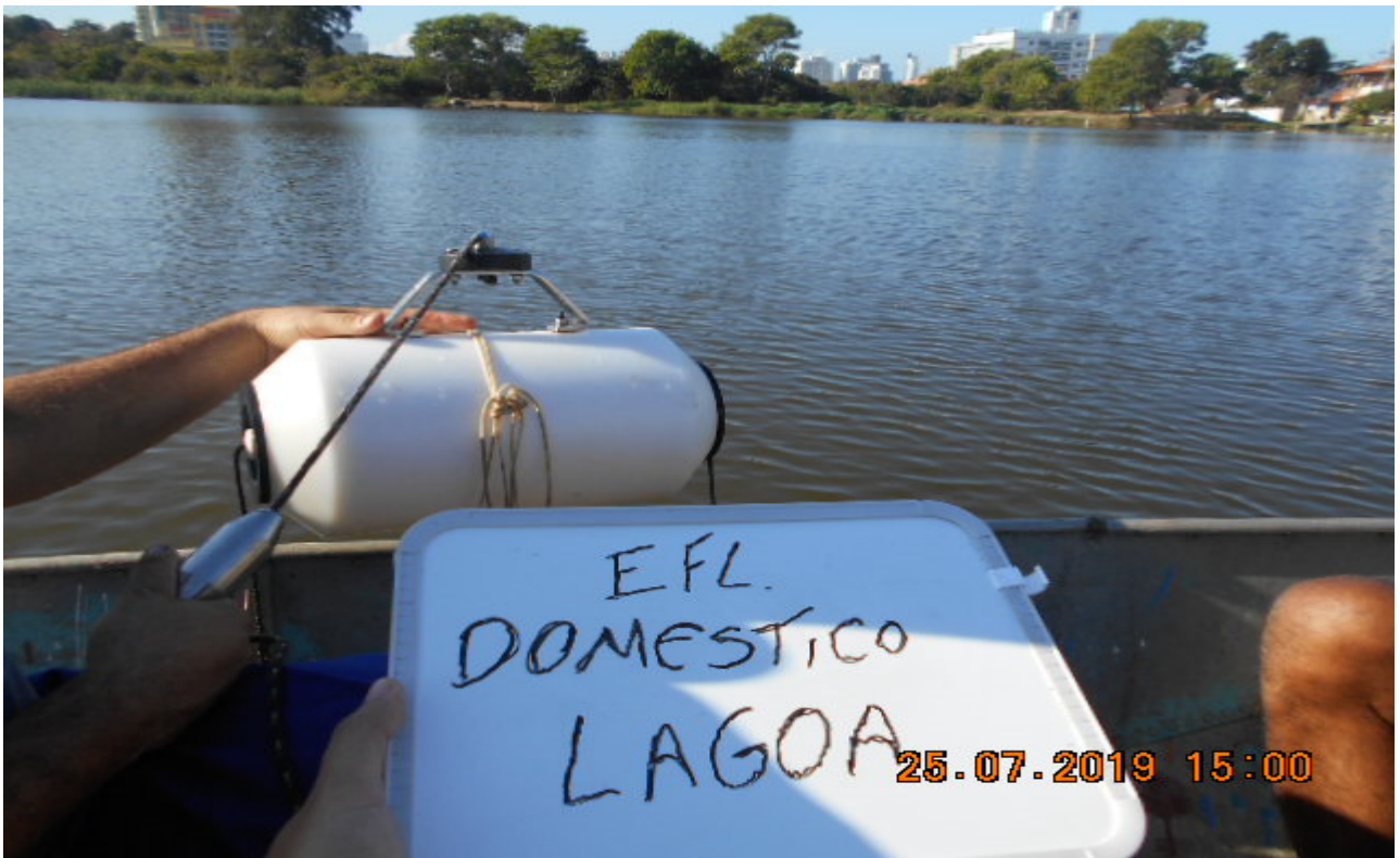
Figura 3: Garrafa de Van Dorn de fluxo horizontal utilizada no processo de amostragem.
