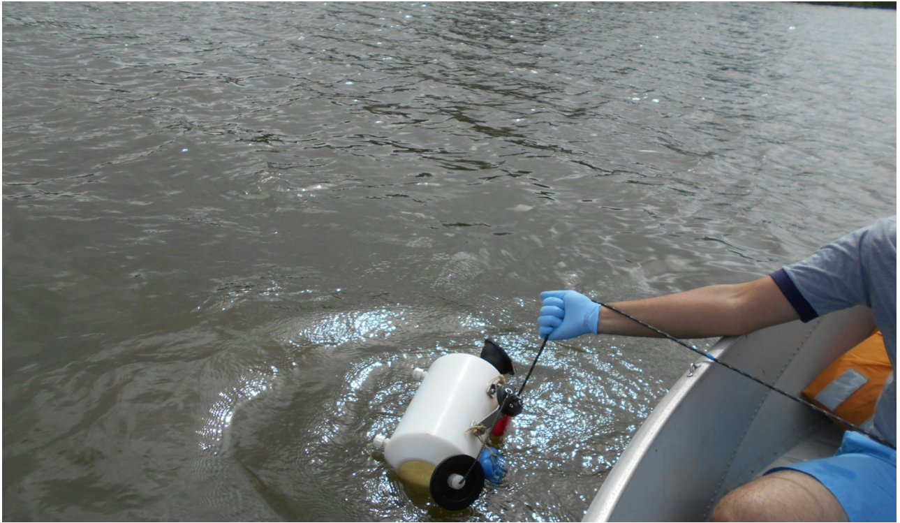
Figura 3: Garrafa de Van Dorn de fluxo horizontal utilizada no processo de amostragem.
