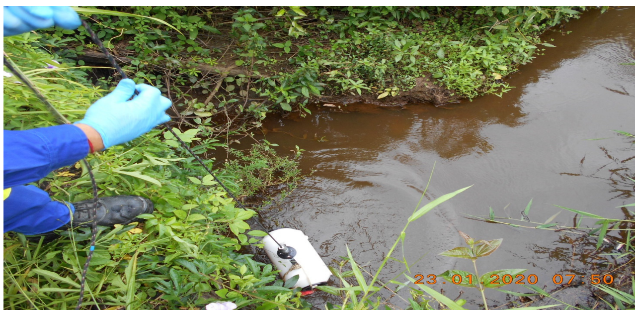
Figura 1: Garrafa de Van Dorn de fluxo horizontal utilizada no processo de amostragem.
