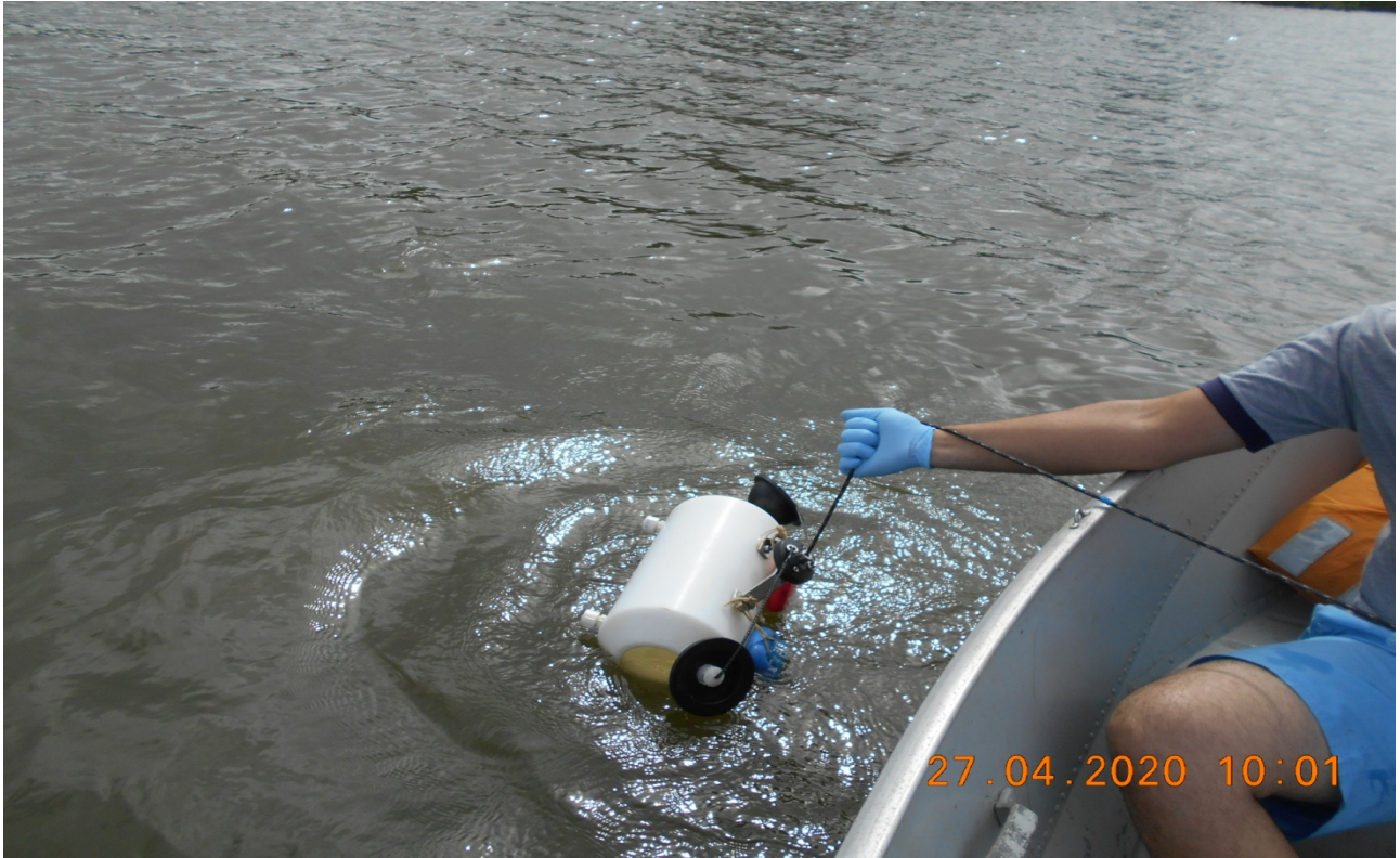
Figura 4: Garrafa de Van Dorn de fluxo horizontal utilizada no processo de amostragem.
