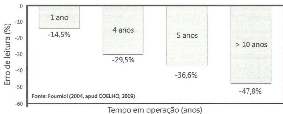
Figura 84 - Erros de medição de hidrômetros resultantes dos ensaios de hidrômetros domiciliares velocimétricos em uma rede de distribuição de Maceió sem intermitência.
