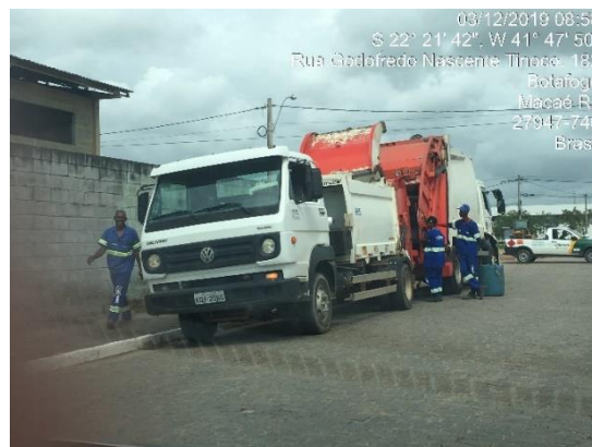
Figura 50 - Caminhão coletor compactador e Transferência de resíduos para transporte até o Aterro. Fonte: SERENCO.
