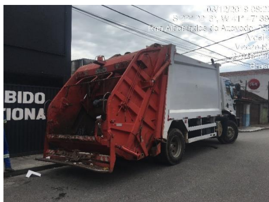
Figura 50 - Caminhão coletor compactador e Transferência de resíduos para transporte até o Aterro. Fonte: SERENCO.
