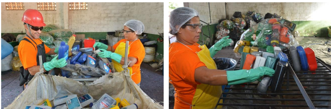
Figura 103 - Segregação e esgotamento de óleo residual.
