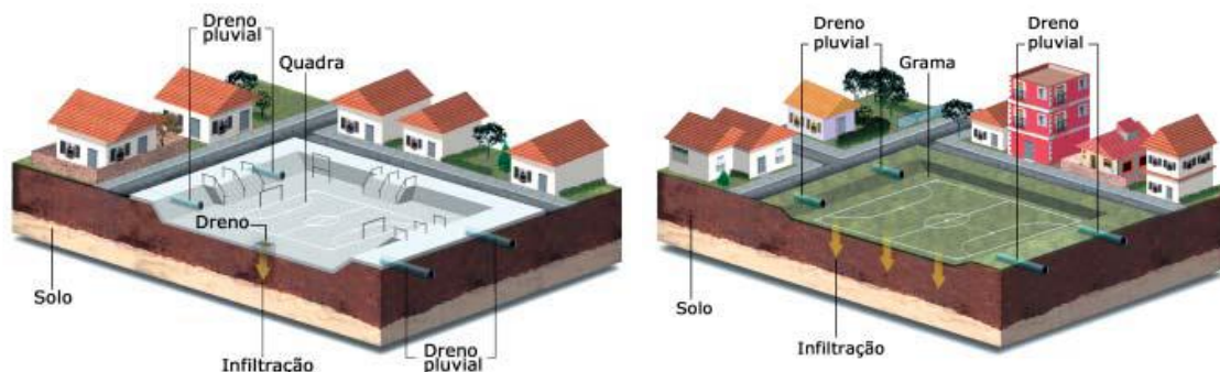
Figura 97 - Bacia de retenção em praça de esportes. Fonte: FEAM, 2006.
