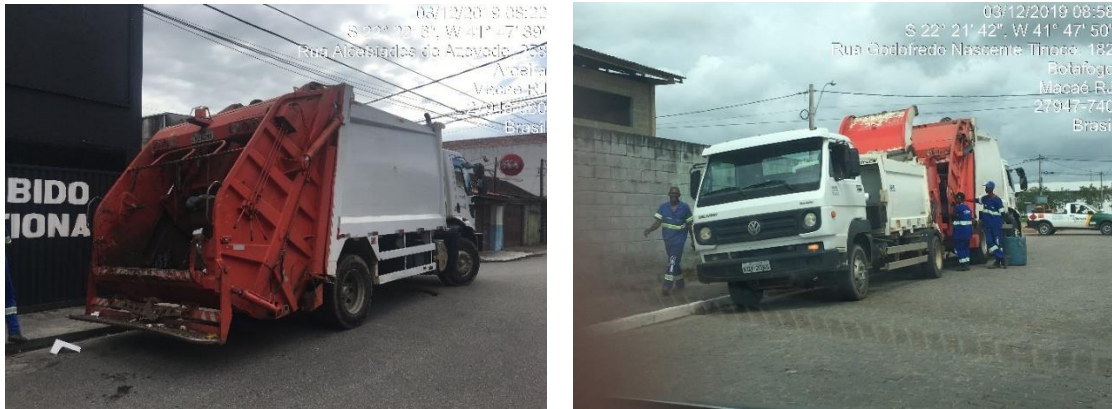
Figura 57 - Caminhão coletor compactador e Transferência de resíduos para transporte até o Aterro. Fonte: SERENCO.
