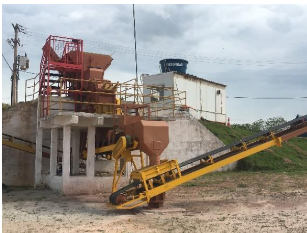
Figura 70 - Equipamentos para reciclagem de RCC no aterro. Fonte: SERENCO.
