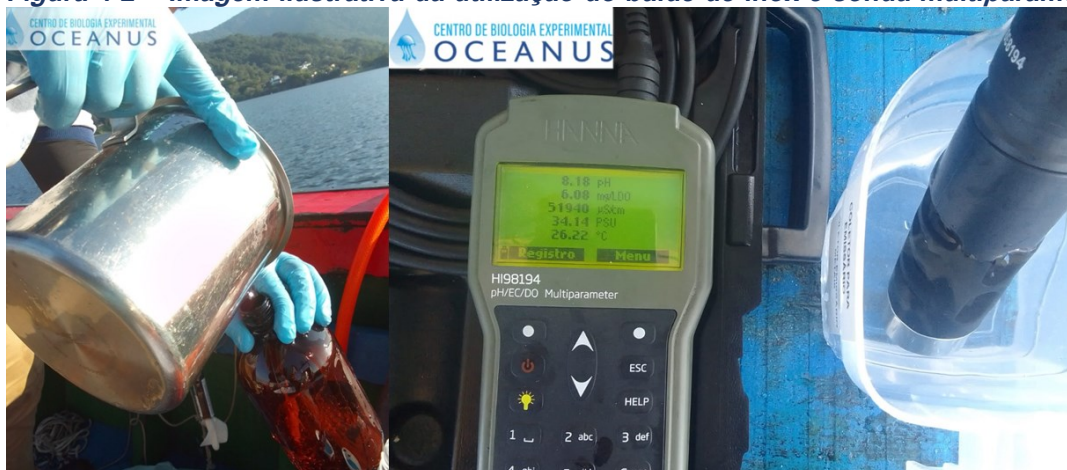
Figura 4-2 – Imagem ilustrativa da utilização do balde de inox e sonda multiparâmetro.
