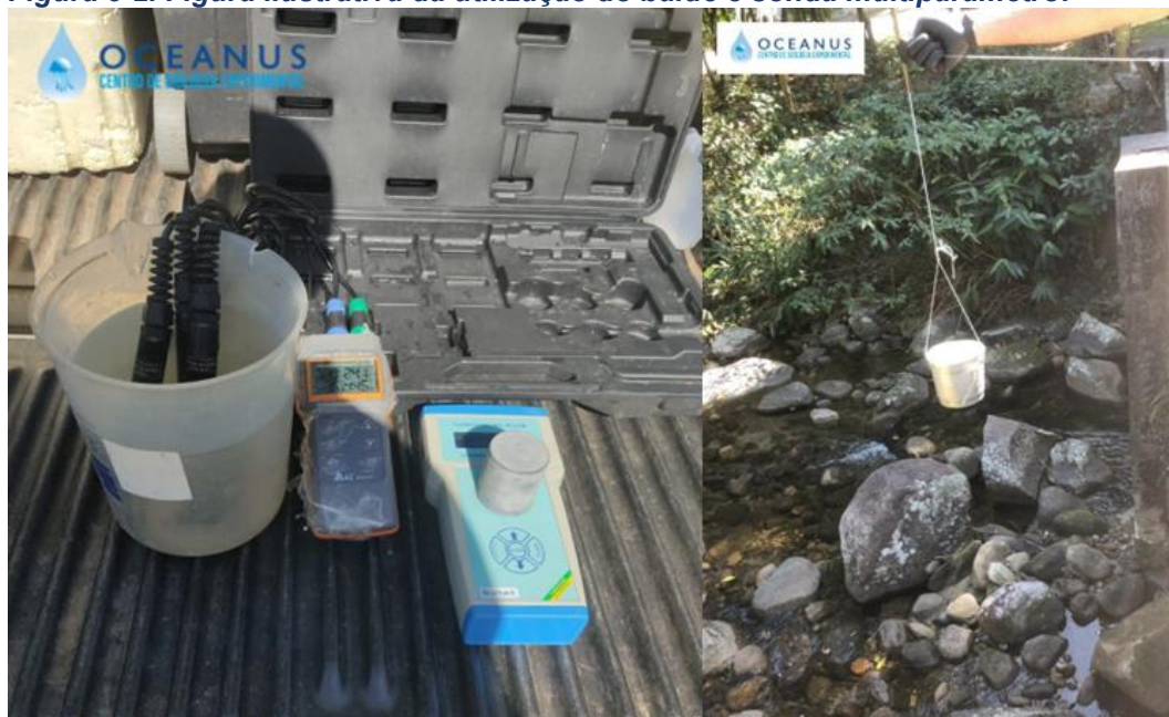
Figura 5-2. Figura ilustrativa da utilização do balde e sonda multiparâmetro.
