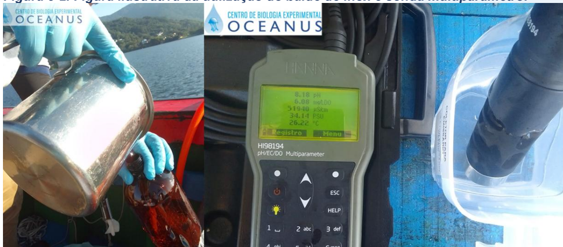
Figura 5-2. Figura ilustrativa da utilização do balde de inox e sonda multiparâmetro.
