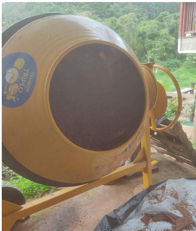
**Figura 43:** Betoneira utilizada para misturar as matérias-primas dos blocos.
