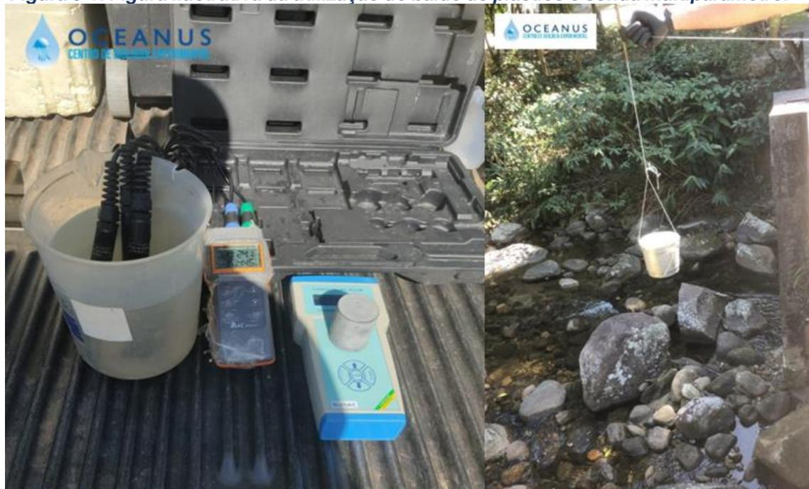
A fim de minimizar os riscos de contaminação das amostras, os equipamentos utilizados durante o processo foram desinfetados com álcool 70%. As amostras foram preservadas com os reagentes específicos, conforme recomendado *pelo Standard Methods for Examination of Water and Wastewater* (APHA, 23<sup>rd</sup> ed., 2017) e o Guia Nacional de Coletas e Preservação de Amostras (CETESB; ANA, 2011), e mantidas sob refrigeração de < 5°C até a entrega ao laboratório.
