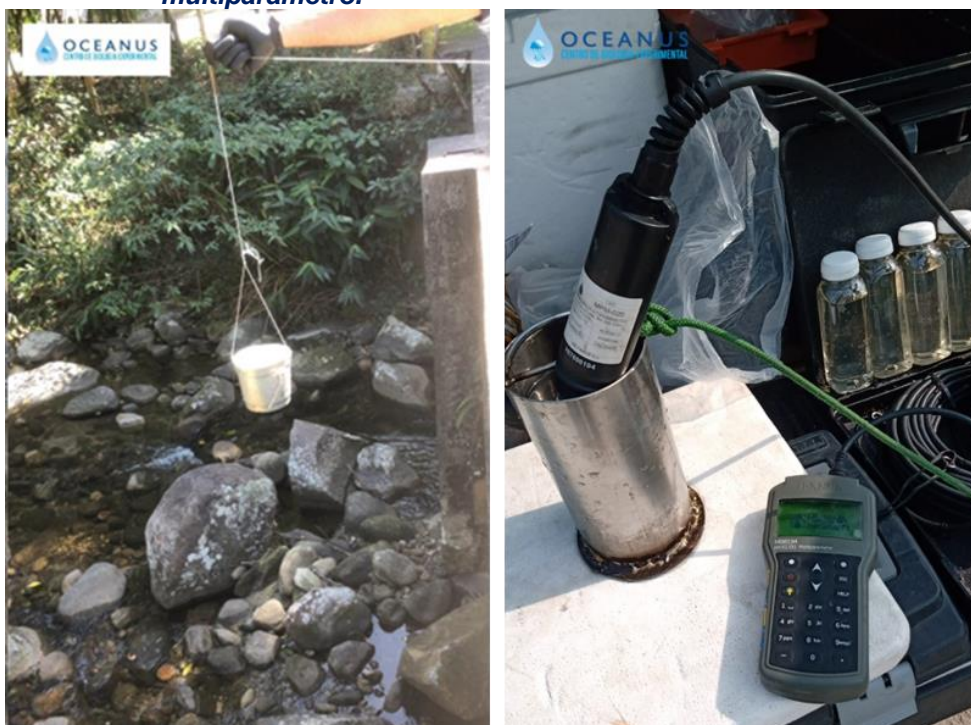
Figura 3-6. Figura ilustrativa da utilização do balde de inox e sonda multiparâmetro.
