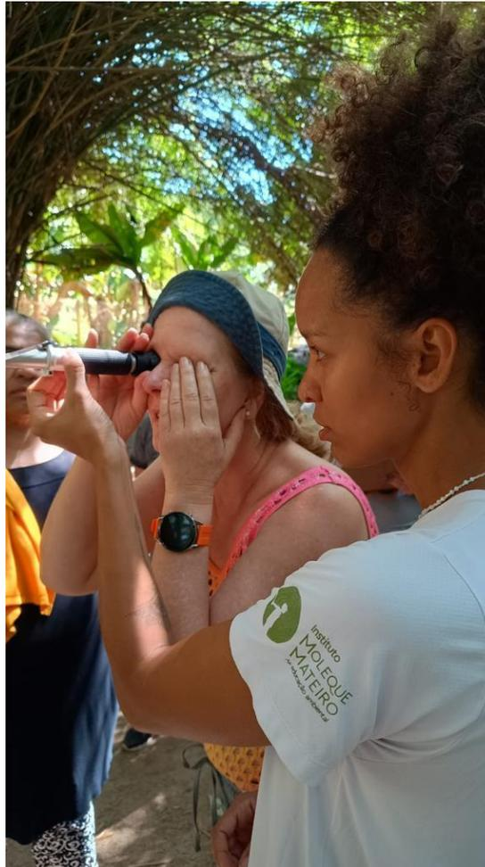
Figura 17 - Análise da amostra de água coletada no Ponto 1 - Macaé de Cima com o particulômetro.
