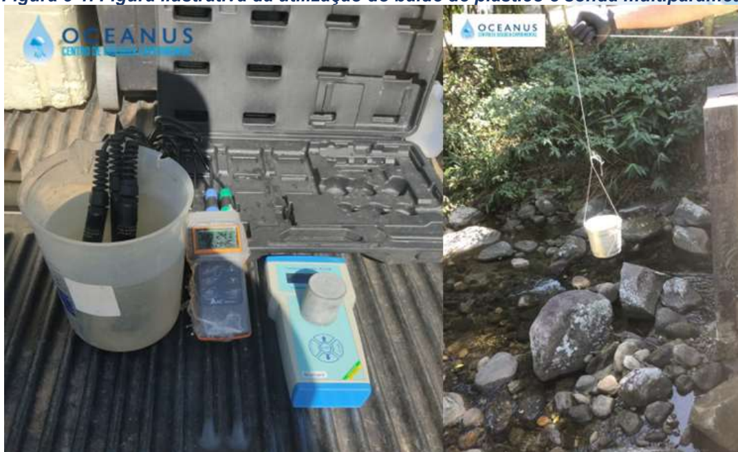
Figura 5-1. Figura ilustrativa da utilização do balde de plástico e sonda multiparâmetro.
