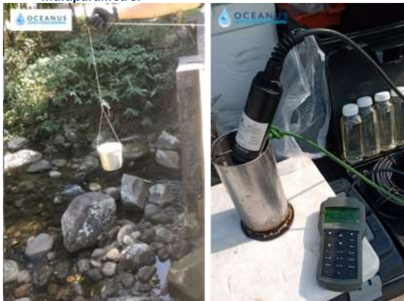
Figura 5-1. Figura ilustrativa da utilização do balde de inox e sonda multiparâmetro.
