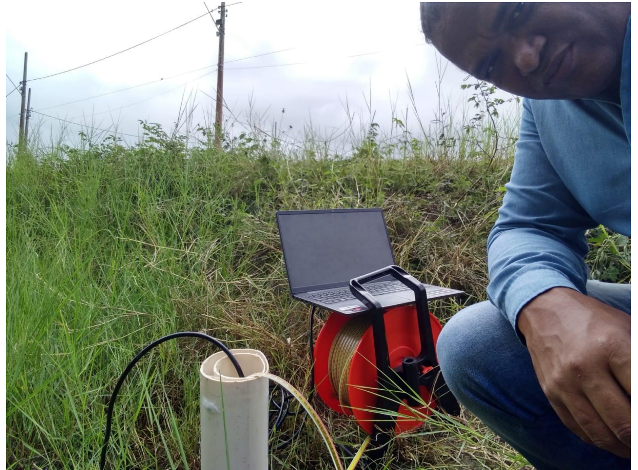
Protótipo de Sensor de Nível hidrostático em plataforma arduino – (Donato et al. 2023)
