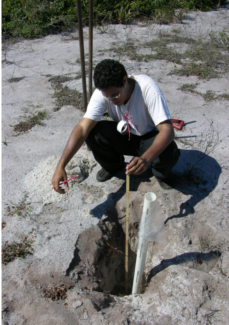
Poço hídrico para medir a superfície freática – (Umbelino, 2008).
